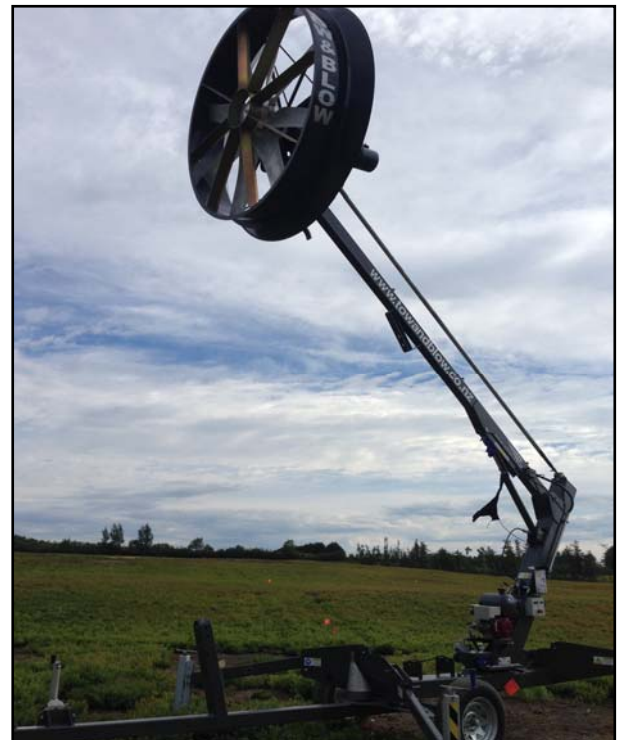
Figure 2. Photo prise le 26 juin 2015 montrant l'éolienne mobile de type « Tow and Blow » déployée dans le champ d'essai
