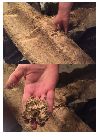
Figure 5. Accumulation de lactosérum sur les pales du mélangeur à RTM
